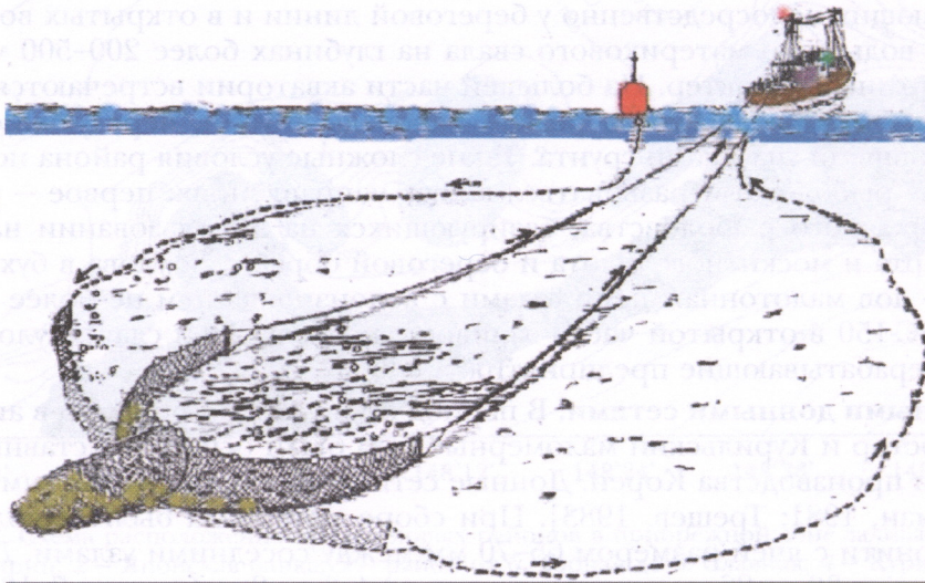
Рис. 3. Схема снюрреводного лова [по Вайниканису-Мирскому, 1953]
