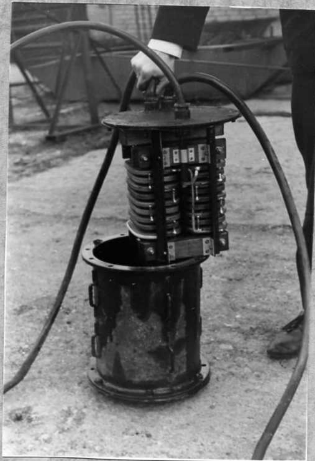
Рис.5 . Общий вид подводного импульсного трансформатора
