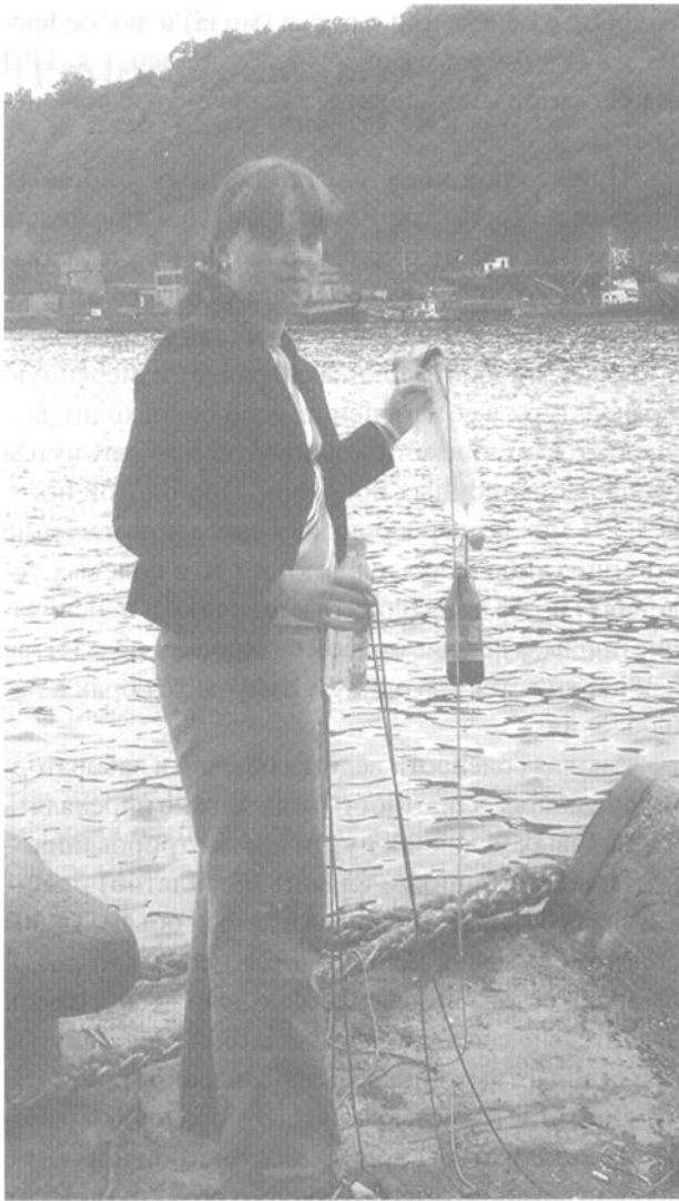
Рисунок. Термопробоотборник (белая пластмассовая бутылка с глубоководным термометром внутри) с поплавком в руке студентки перед броском с пирса морского вокзала (Авачинская губа, Камчатка)
