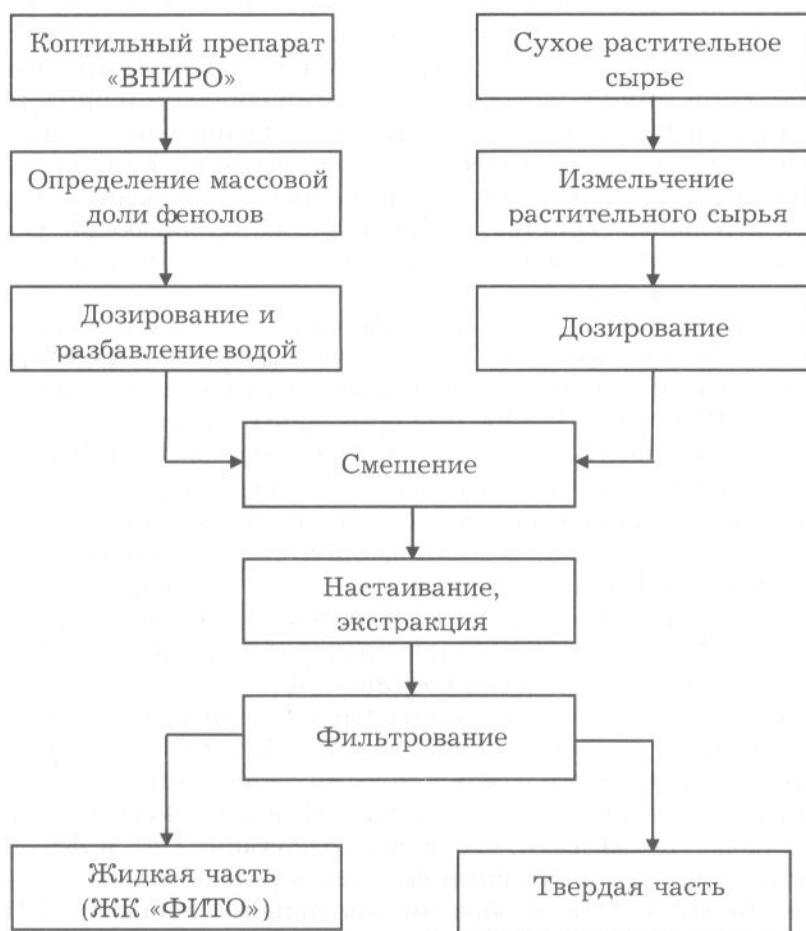
Рис. 1. Схема технологического процесса изготовления ЖК «ФИТО»
