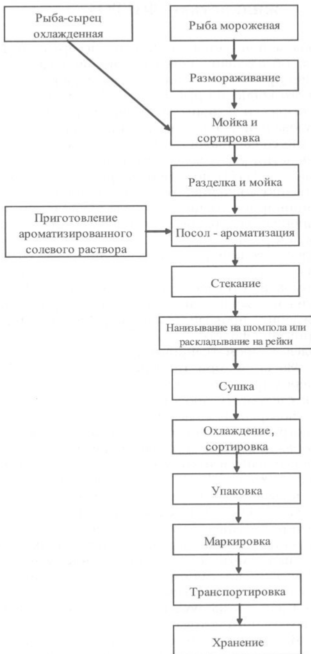
Рис. 10. Схема технологического процесса изготовления рыбы холодного копчения с ЖК «ФИТО»
