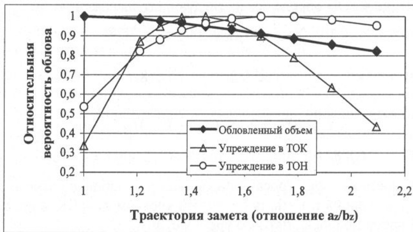
Рис. 2. Вероятность облова косяка при различной траектории замата. Fig. 2. Probability of catching jamb at a various trajectory of encircles.
