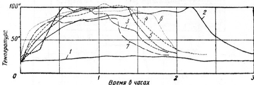
Рис. 14. Термограммы дыма на выходе из дымогенератора Цукурса и Кромбергса без регулировки отбора дыма:
