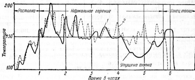
Рис. 8. Термограмма дымовых газов на выходе из дымогенератора: 1—испытание № 12 от 24 мая 1956 г.; 2—испытание № 13 от 25 мая 1956 г.
