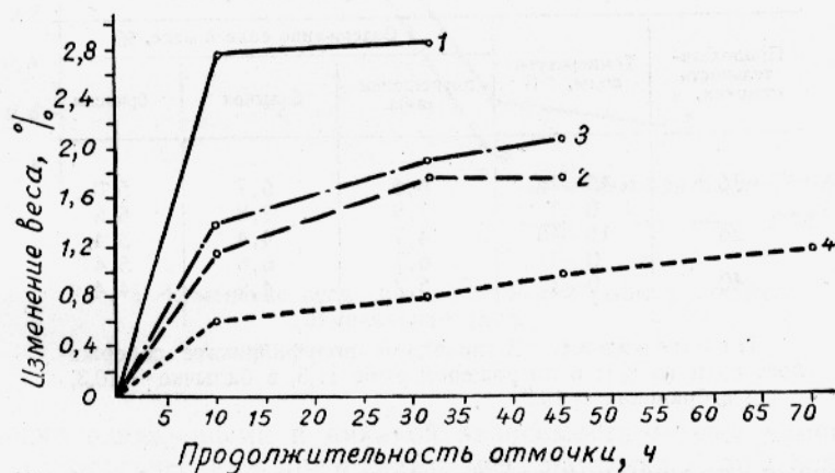
Рис. 4. Изменение веса отмачиваемого полуфабриката (в %): 1 — балычка при 16°С; 2 — балычка при 0°С; 3 — потрошеной рыбы при 16°С; 4 — потрошеной рыбы при 0°С.
