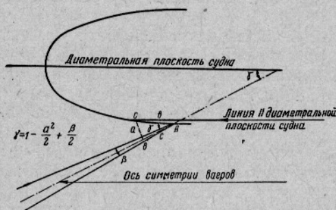
Рис. 10. Схема измерения угла между ваерами и диаметральной плоскостью судна.
