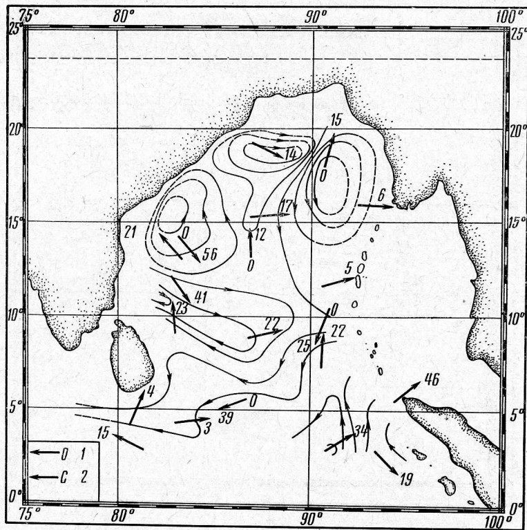
Рис. 4. Динамические карты Бенгальского залива: a — поверхность океана; б — поверхность 50 дцб; в — поверхность 100 дцб; 1 — остаточное течение; 2 — течение, рассчитанное по методу Сысоева. Изолинии на картах проведены через 50 дин. мм.
