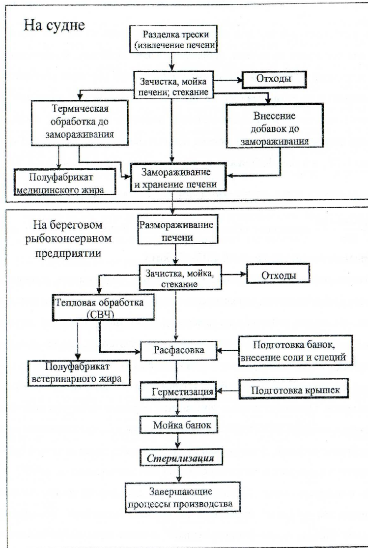
Рисунок 5. Обобщенная технологическая схема производства консервов
