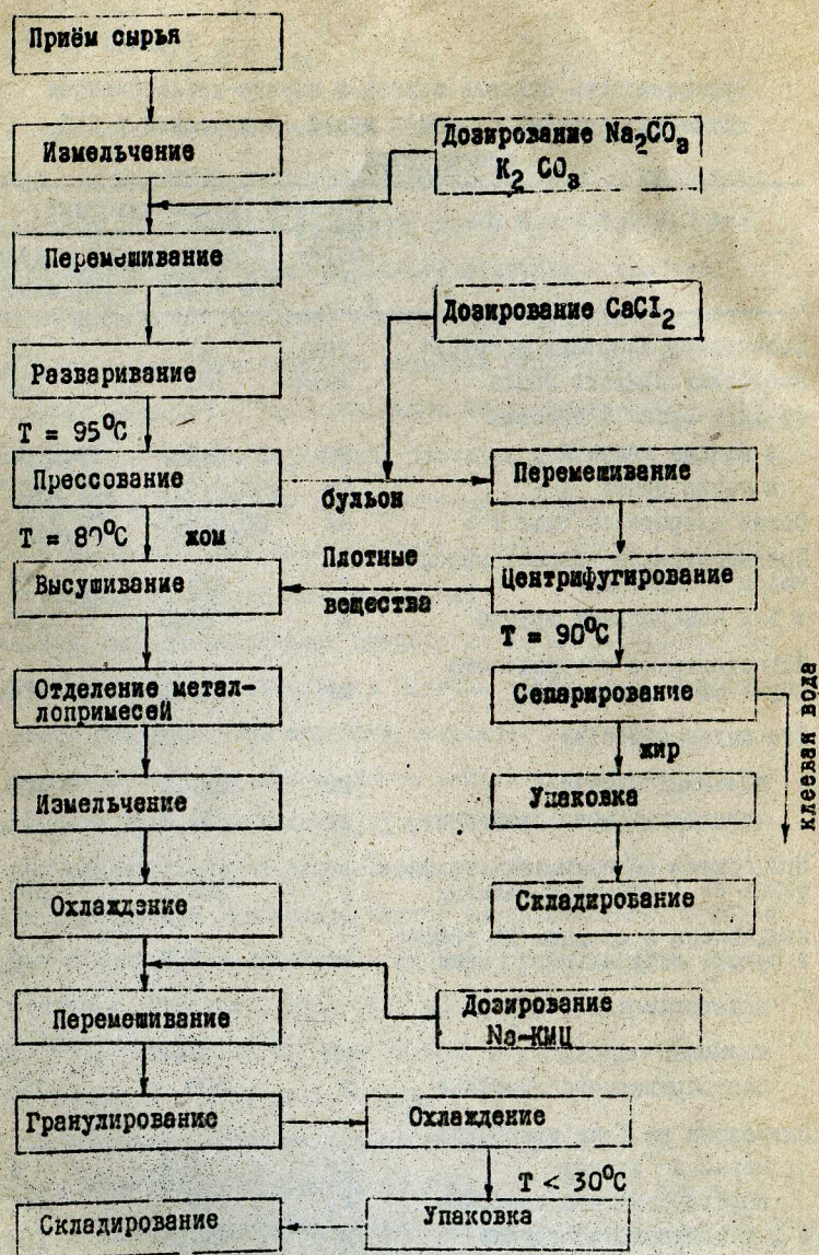
Рис.4. Технологическая схема производства кормовой рыбной муки и жира по прессово-сушильной схеме
