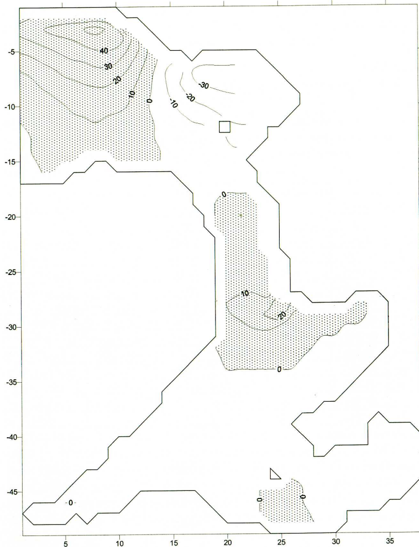
Рисунок 12 – Трансформация фаз (град.) приливной волны M_2 при наличии дамбы ПЭС
