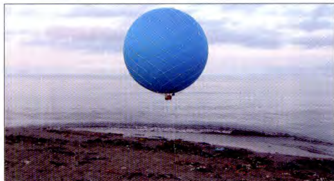
Фото 1. Резиновый шар. Диаметр 120 см, грузоподъемность 650 г. Видна прикрепленная к оплетке пластмассовая оправка для фотоаппарата
