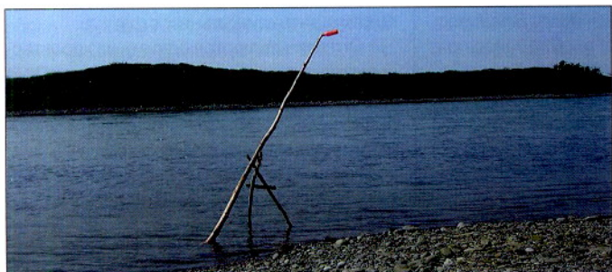
Фото 1. Установка «наклонный шест» для фотографирования водоема сверху
