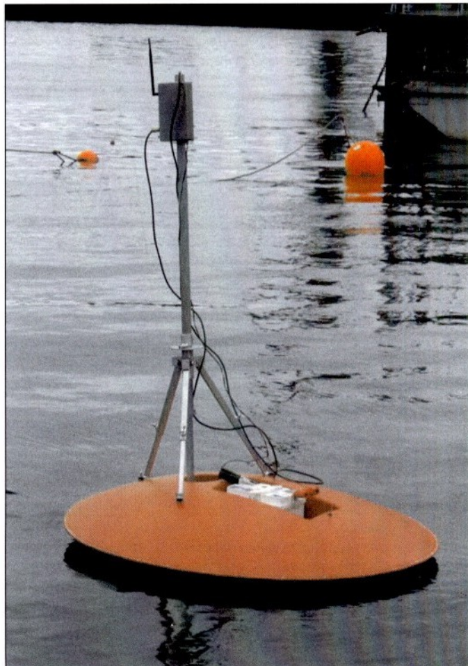
Плавающая гидроакустическая высокочастотная многолучевая станция комплекса NetCor
