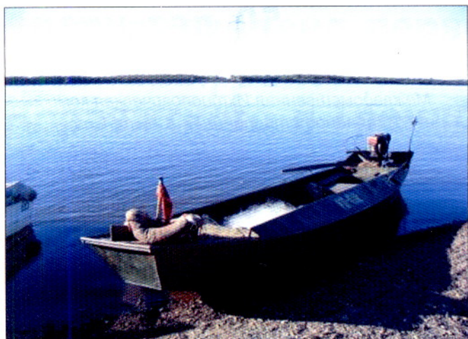
Фото 1. Китайские рыбаки – профессионалы. Их металлические джонки специально спроектированы для работы со сплавной сетью длиной в несколько сотен метров. Двигатели на них простые, надежные и экономичны. Китайскую лодку изредка можно увидеть и у российских рыбаков. На участке лицензионного лова кеты в Амурской протоке (около Хабаровска), сентябрь 2003 г.
