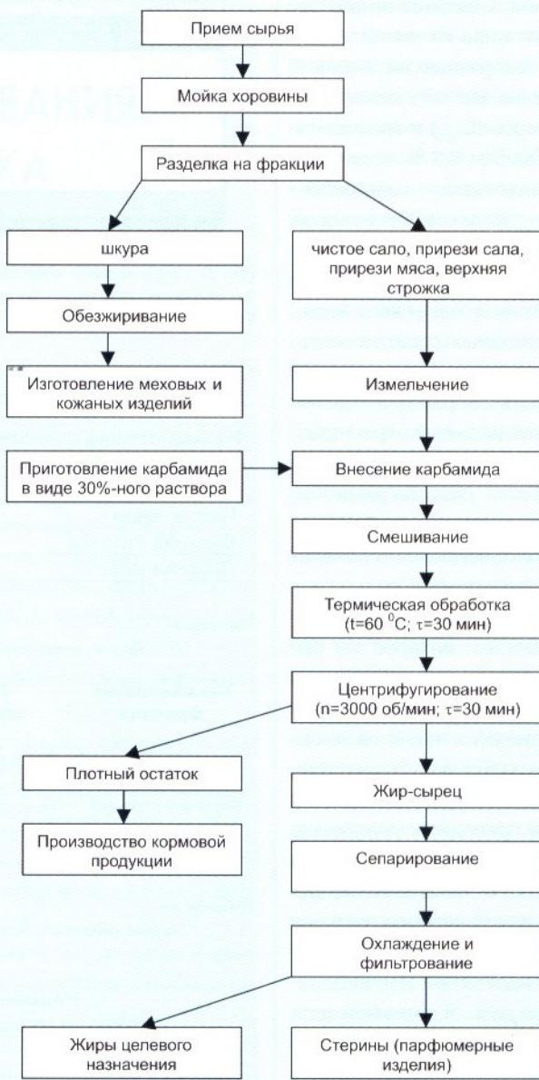
Рис. 2. Технологическая схема обработки хоровины тюленя
