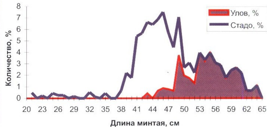
Рис. 3. Размерный состав обловленного скопления минтая и улова при использовании траловых мешков из полиэтиленовой безузловой дели с увеличенным шагом квадратной ячеи ( a = 50 и 60 мм): верхний график – B = 90 мм; нижний – B = 110 мм
