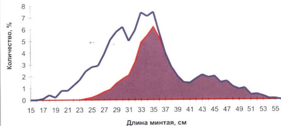
Рис. 2. Избирательность лова минтая при использовании траловых мешков с квадратной формой ячеи: верхний и средний графики – при различной степени смешения скоплений траловый мешок из полиэтиленовой безузловой дели; нижний – траловый мешок отечественной конструкции из капроновой узловой дели с двойной комплексной ниткой
