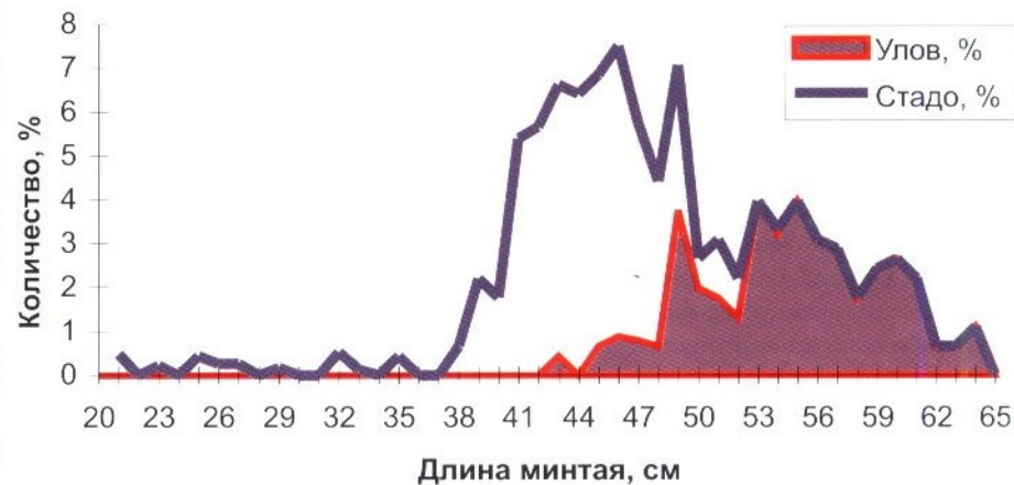
Рис. 3. Размерный состав обловленного скопления минтая и улова при использовании траловых мешков из полиэтиленовой безузловой дели с увеличенным шагом квадратной ячеи ( a = 50 и 60 мм): верхний график – V = 90 мм; нижний – V = 110 мм
