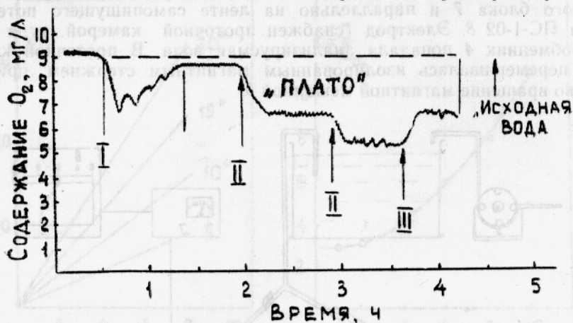
Рис. 5. Изменение содержания кислорода в респирометре в зависимости от расхода воды:
