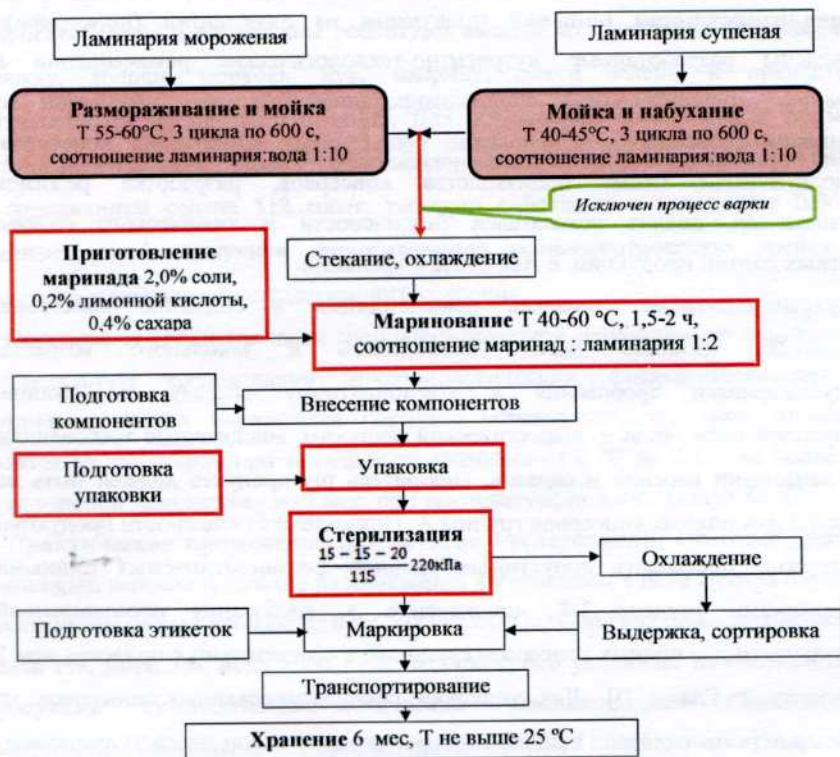
Рисунок 5 – Технологическая схема производства стерилизованной продукции из ламинарии (консервов)
