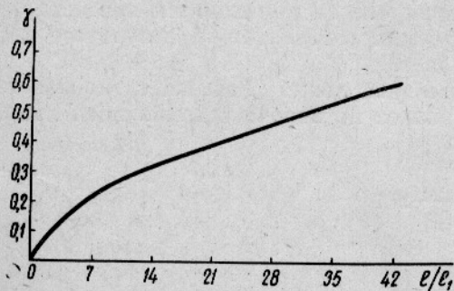
Рис. 1. Зависимость производительности рыболовного эрлифта от протяженности пульпопровода.
