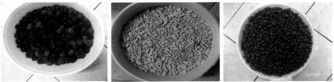
Рис. 2. Испытанные наполнители: A — пластиковые «биошары», B — коралловая крошка, B — керамзит
