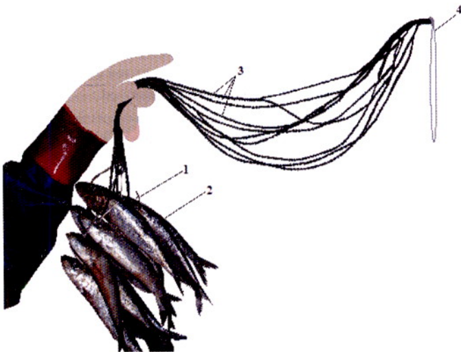
Рис. 5. Пучок крючков с поводцами, наживленных сардинкой: 1 – крючок; 2 – наживка; 3 – поводцы; 4 – веревочная петля для подвязывания пучка поводцов (10 шт.) к петле бетонного груза
