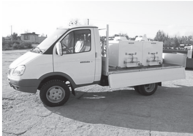
Рис. 95. Установки живорыбных контейнеров фирмы SDK на автомобиль «Гель»
